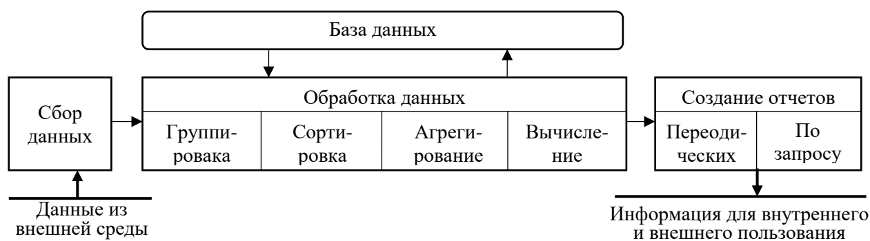
Рисунок 1 – Схема работы информационной системы [5]
