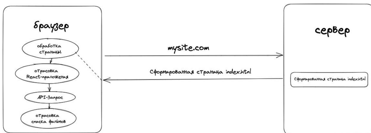
Рисунок 1 - Схема работы генератора статических сайтов SSG
